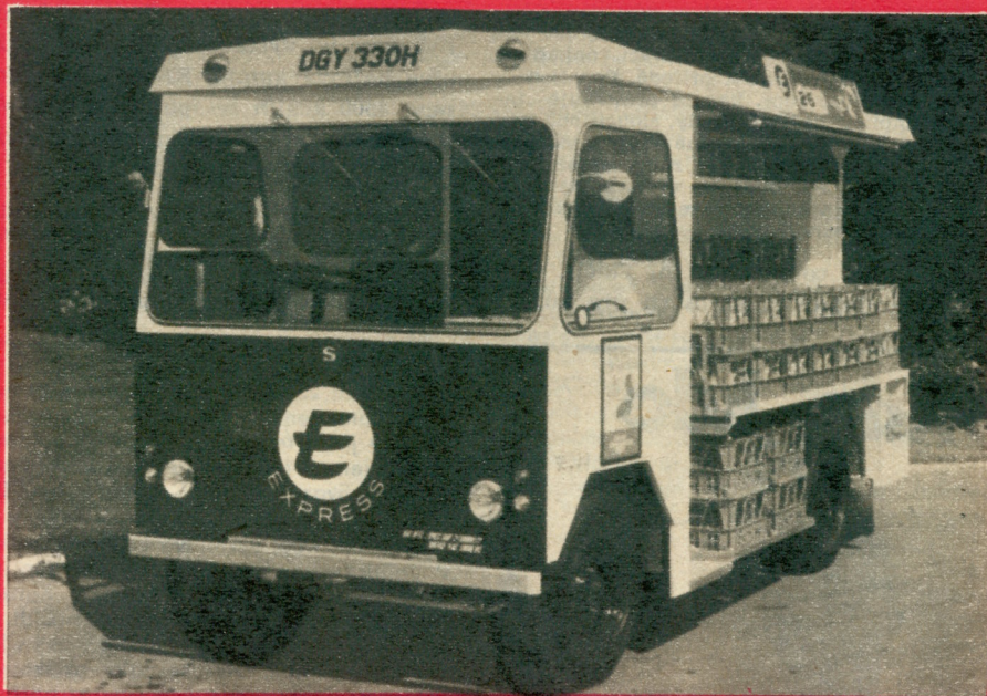
V zahraničí se již rozvážkové elektromobily vyrábějí. Na obrázku výrobek anglické firmy Smiths Electric Vehicles pro rozvoz mléka.
